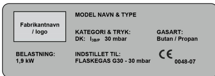
Figur 5-19. Eksempel – Mærkeskilt på køleskab.
