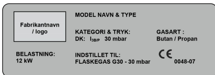
Figur 5-12. Eksempel – Mærkeskilt på vaskemaskine/tørretumbler.
