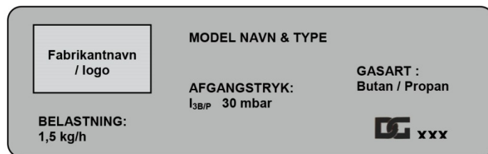
Figur 5-1. Eksempel – Mærkeskilt på regulator.
