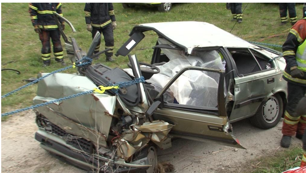
En ældre Volvo "åbnes" hurtigt ved hjælp af træk og modhold med kæder
