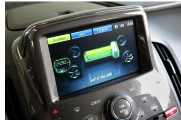
Instrumenter i plugin hybridkøretøjer, med den store kraftfordelingsskærm typisk placeret centralt i instrumentbordet. Dette eksempel er fra plugin hybriden Opel Ampera.
