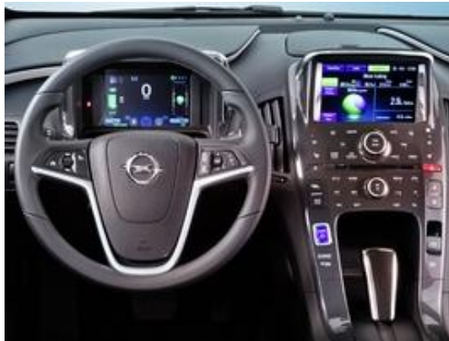
Instrumenter i plugin hybridkøretøjer, med den store kraftfordelingsskærm typisk placeret centralt i instrumentbordet. Dette eksempel er fra plugin hybriden Opel Ampera.
